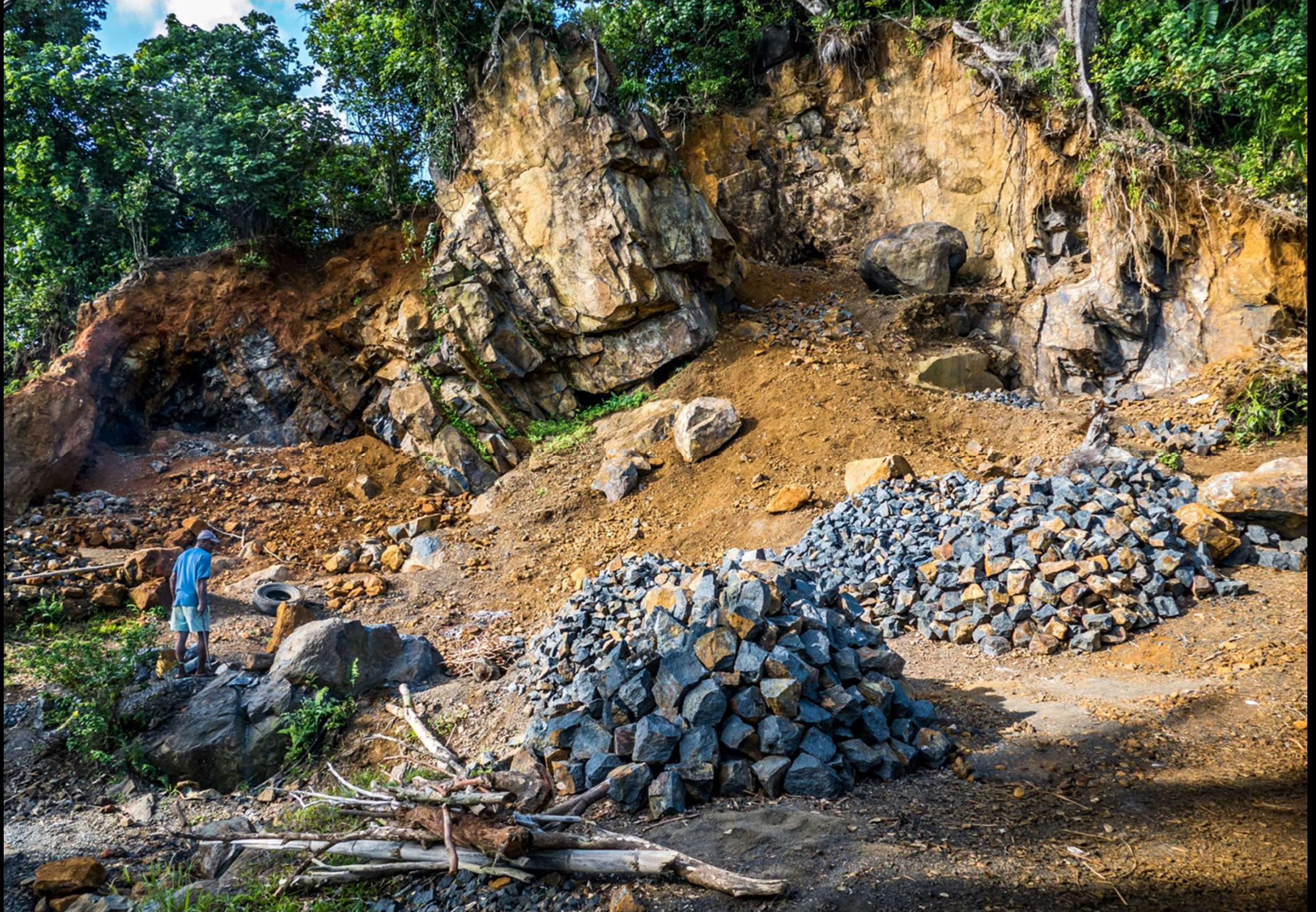
Οικογενειακό λατομείο, και ο τρόπος που δουλεύουν θυμίζει κάτεργο για φυλακισμένους. Όπως και στα τούβλα, έτσι και εδώ, όλα γίνονται με τα χέρια. Οι μεγάλες πέτρες πάνε για χτίσιμο και οι μικρότερες στο σκυρόδεμα.
