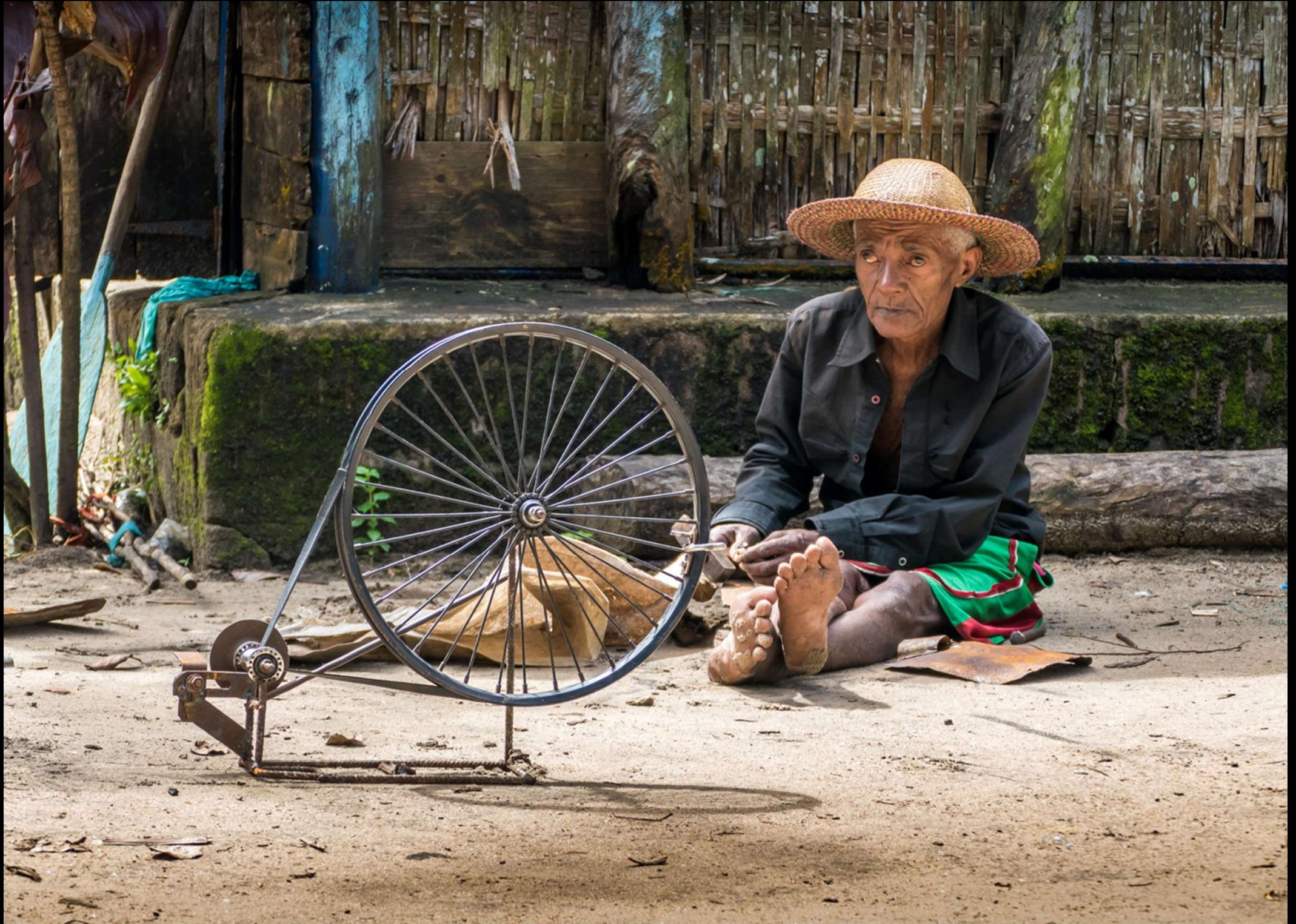
Ο μάστορας είναι ο σιδεράς του χωριού, και αυτή η απλή κατασκευή από εξαρτήματα ποδηλάτου είναι χειροκίνητο δισκοπρίνο.
